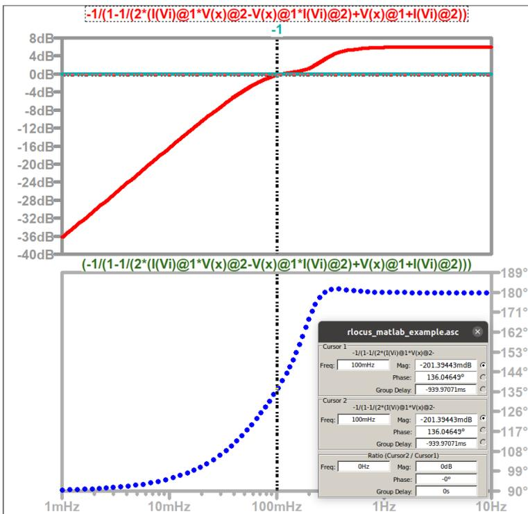
in dieser Simulation sieht man, dass bei  $k=1$  der Schaltkreis stabil ist. ( Eigentlich ist hier  $k=-1$ , aber die Rückführung der Regelschleife wird beim  $+$  des Addierers eingespeist, daher muss  $k$  negativ sein).
