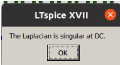
d.h. die Laplace-Beschreibung der Strecke hat einen Pol bei  $s=0$  ( $f=0\text{Hz}$ , also Gleichstrom). Um dies zu bereinigen muss der Pol etwas nach links in der  $s$ -Domäne verschoben werden. Laplace= $(0.5*s+1.3)/((s+0.1)*(s^2+1.2*s+1.6))$ .
